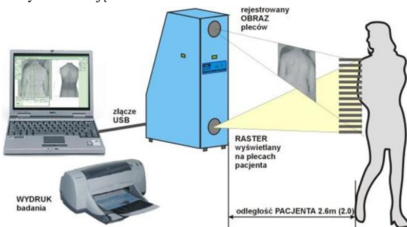
Ryc. 4. Schemat badania postawy ciała za pomocą aparatury MORA
